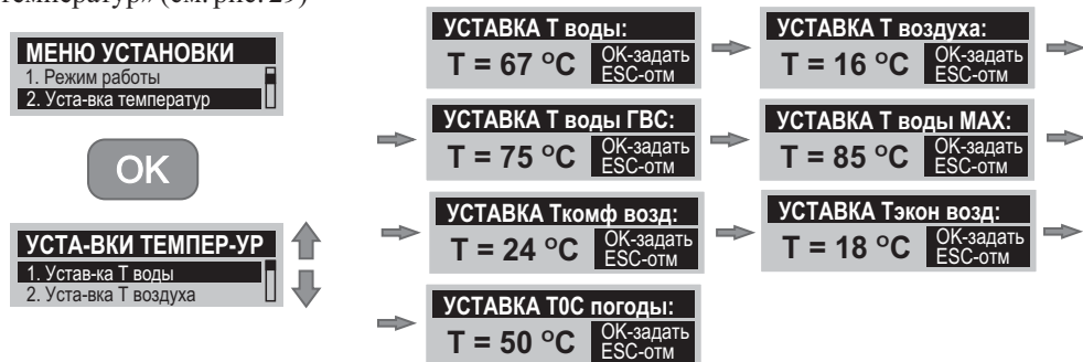
Рисунок 29. Установка температурных параметров.
